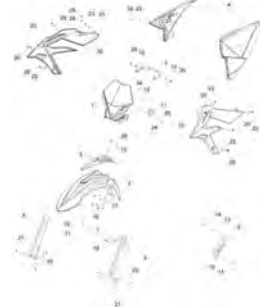
TAV.43A Carenature-Parafanghi - Mudguards - Carenages-Gardeboues - Verkleidungen-Koiflügel - Carenados-Guardabarros
