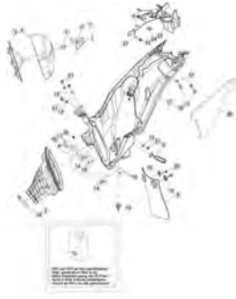
TAV.38 Scatola filtro - Filter box - Boî tier du filtre - Sicherungskasten - Caja del filtro
